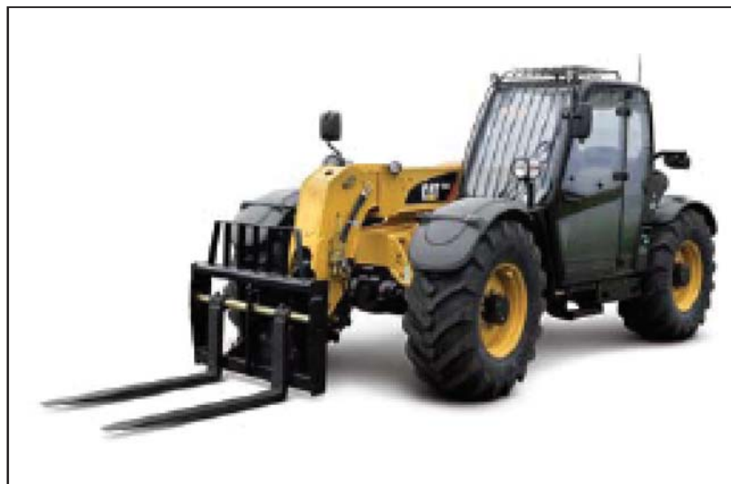
Slika 4. Teleskopski manipulator za utovar i manipulaciju krutim stajskim gnojem.
